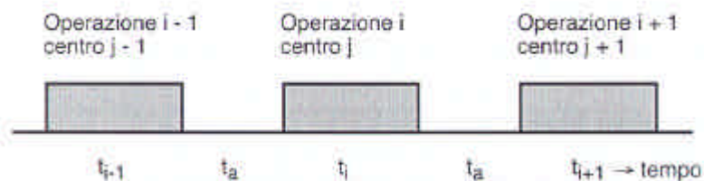
Fig. 1.10. Schema dei tempi in gioco in un S.P. di tipo Job-Shop. I segmenti " t_a " rappresentano il tempo dovuto a: trasferimento da centro a centro e superamento della fila d'attesa; i segmenti tratteggiati rappresentano i tempi di lavorazione vera e propria.
